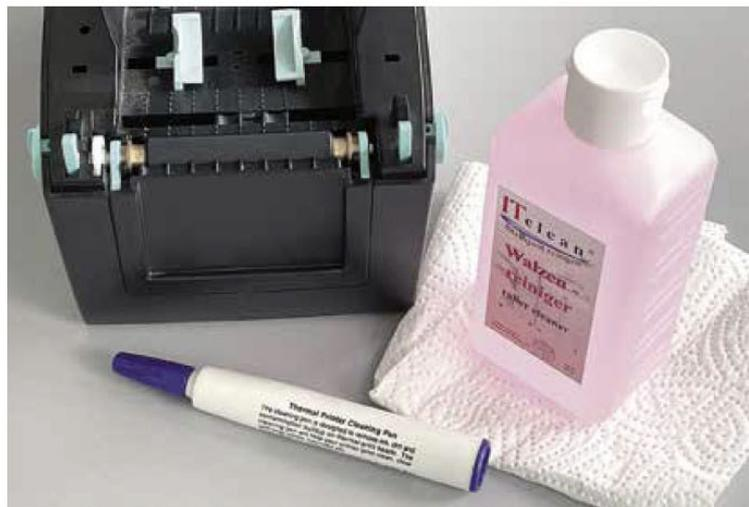
Etikettendrucker intelligent reinigen: Dazu braucht es ein nur entsprechendes Reinigungsmittel, einen speziellen Reinigungsstift und ein saugfähiges Küchentuch.
