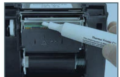
Die speziell geformte Spitze des extra4-Reinigungsstifts kann einfach und gezielt eingesetzt werden, ohne dabei Bauteile unabsichtlich zu beschädigen.
