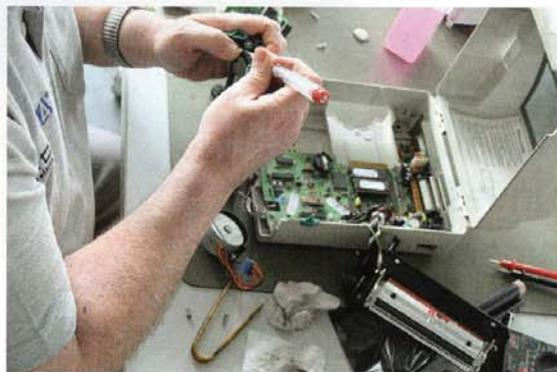
*eXtra4-Techniker Hartmut Kasper zerlegt einen reparaturbedürftigen Thermo-transfer-Etikettendrucker (o.); Reparatur-Check auf „Herz und Nieren“ bei einem defekten Alt-Gerät (u.)*
