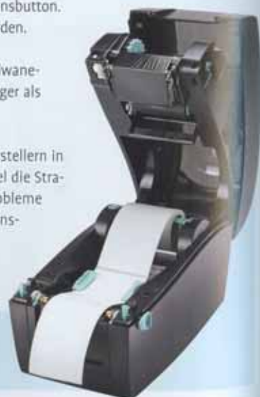
Clam-Shell-Bauweise der Thermotransfer-Drucker RT-Serie von Godex
